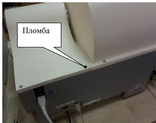
Рисунок 2 – Коагулометр автоматический CoaLAB 1000. Расположение пломбы.
